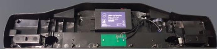
Deux batteries Li-Fe 7Ah 12V
